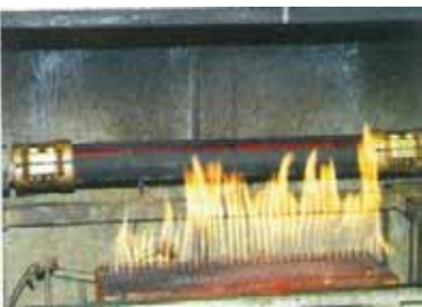
Manguera especial de caucho para refrigeración de hornos eléctricos. Hasta 1.100°C.
