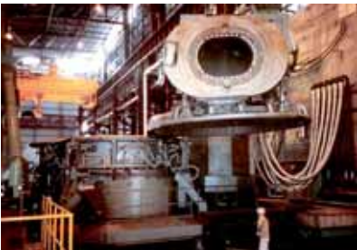
Mangueras de caucho para refrigeración, de hornos en acerías.
